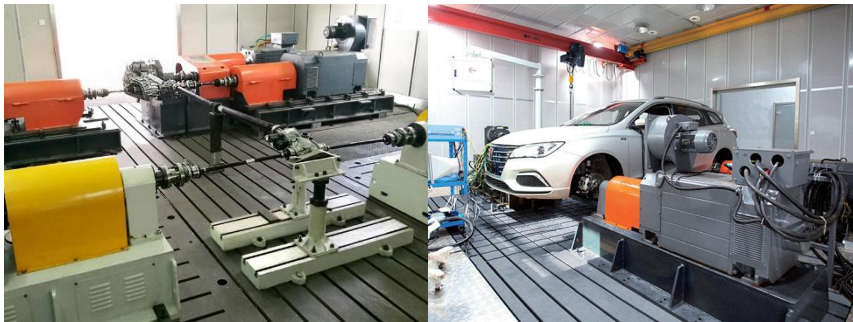
注：左图为公司的变速箱及动力总成测试台架；右图为公司的新能源汽车整车能量流性能测试验证服务
