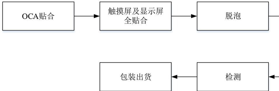
触控显示模组的生产加工主要工序简介：
