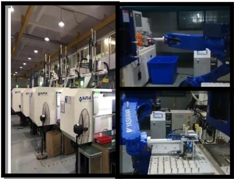
自动化精密注塑系统能够实现塑料原材料的自动烘料、智能吸取上料，并配备了机械手或多关节机器人从事辅助，实现全程无人化操作和实时监控。
