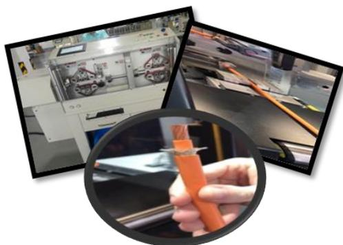
✚线束自动裁切设备通过控制系统实现多种类型线束的自动裁切、自动剥皮以及编制，实现了手工作业无法达到的精密度、齐整度和一致性
