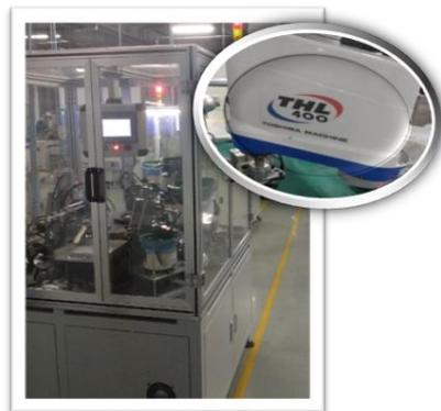
✚自动组装线还配置螺丝自动锁紧、自动点胶设备，能够实现不同产品紧固件拧紧的智能识别以及自动点胶，使得紧固件锁附扭矩和角度要求达到标准
