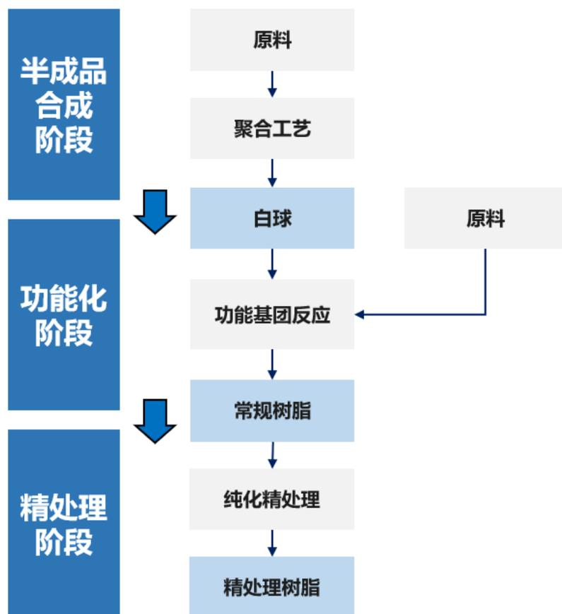
发行人产品规格型号较多，不同型号加工工艺不完全相同，由于阴离子树脂与阳离子树脂、凝胶型树脂与大孔型树脂、精处理树脂与常规树脂在原材料及生产工艺上存在较大差异，故以发行人销量较高且涵盖上述不同原材料及生产工艺的 201×7 强碱性凝胶阴树脂（精处理级）、D001 大孔强酸性阳树脂为例，工艺流程图如下：
