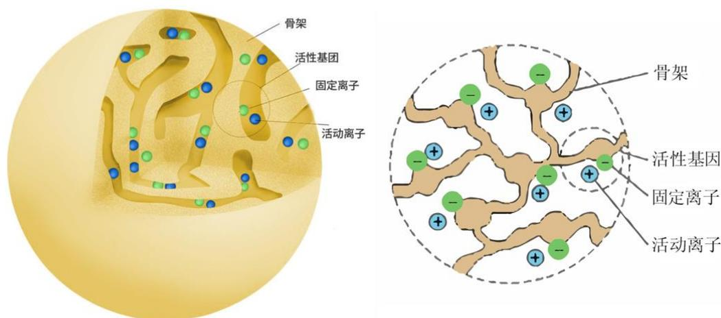
离子交换树脂是一种带有交联剂的高分子化合物，树脂内部是一个立体的网状结构作为骨架，连接在离子交换树脂骨架上的活性基团能在水溶液中离解出活动离子，这些离子在较大范围内可以自由移动并能扩散到溶液中。同时，溶液中的同类型离子也能扩散到整个离子交换树脂多孔结构内部。这两种离子之间的浓度差推动它们互相交换，而且其浓度差越大，交换速度越快。由于离子交换树脂上所带的一定的功能基团对于各种离子的亲和力大小各不相同，所以在人为控制的条件下，功能基团离解出来的可交换离子就可与溶液里的同类型离子发生交换。
