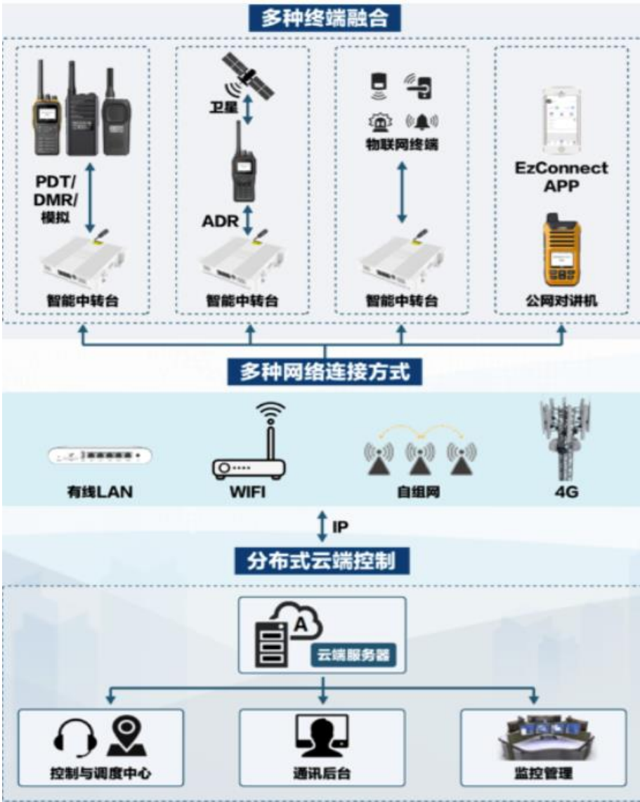
图 AES 系统架构图
