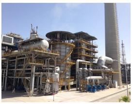
炼油加热炉中,常减压装置是原油初加工装置,其处理能力决定了整个炼油厂加工能力或规模。在常减压装置中,常减压炉的处理能力决定了常减压装置处理能力,如常减压炉处理能力不够,整个装置将无法完成预定的任务。从此意义上讲,常减压炉的处理能力决定了整个生产装置甚至整个炼油化工企业加工能力或规模。
