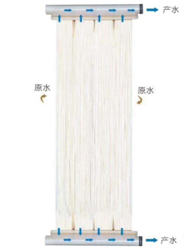
膜组件工作原理示意
