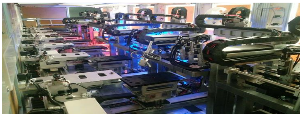
图 2：液晶显示屏防尘屏蔽带贴装线
