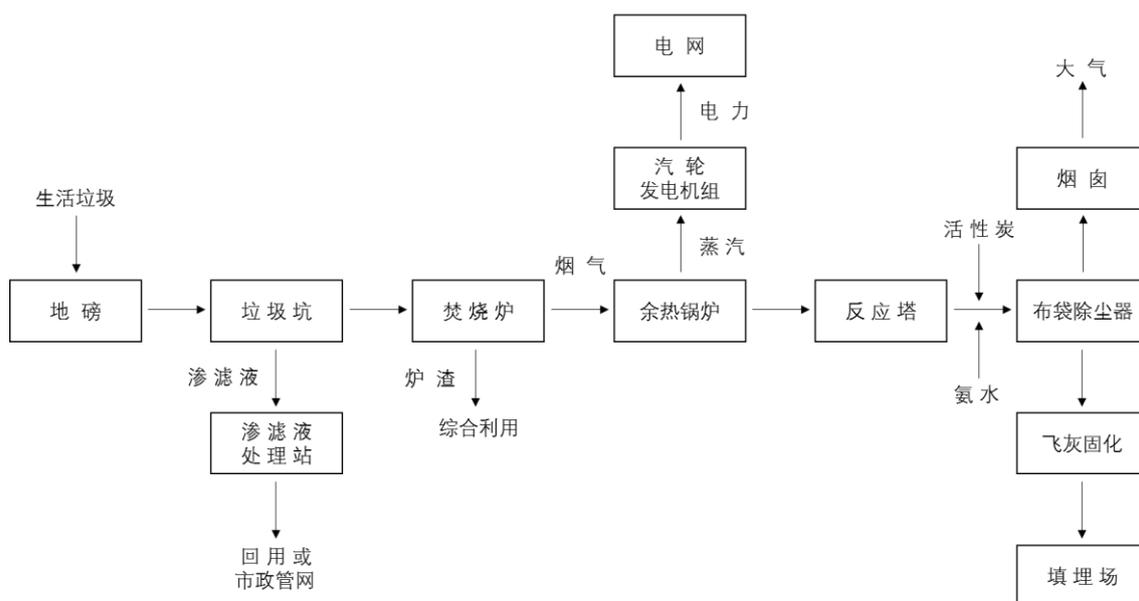
垃圾焚烧发电系统的核心设备是焚烧炉，公司主要使用自主研发的三驱动逆推式炉排炉，该种焚烧炉具有独特的一体式三段设计，干燥、燃烧、燃烬段均配置独立驱动机构，可灵活根据燃烧工
