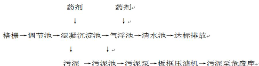
阔丹凌云综合污水处理站设计处理能力 80m<sup>3</sup>/d，主要收集处理公司及新建办公楼生活污水；下半年完成工业污水处理站建设工程，目前已完成验收，属于提标建设项目。
