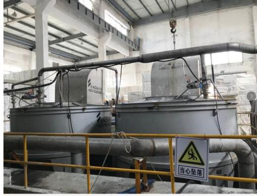
绍兴唯尔福实业投入 100 万元，购置 2 台全自动中浓水力碎浆机，实行技改升级，淘汰原先耗电大、碎浆效率低的低浓碎浆机。新碎浆机于 10 月 25 日正式投入生产。技改后的中浓水力碎浆机在 10-15% 浓度下就可疏解纸浆，其动力消耗可较低浓碎浆机节约 25-30%。
