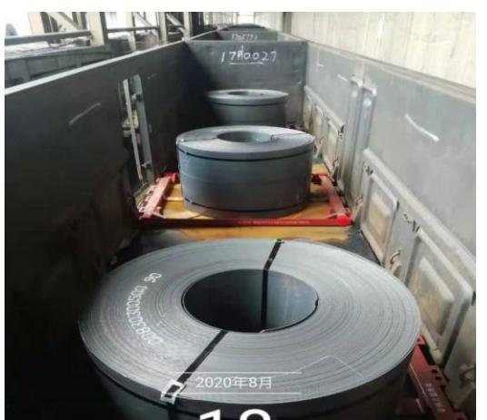
公司自主研发 L 型立装卷钢托架，并制定了该系列托架物流装载运输方案，该方案的使用提高了立装卷钢的运输效率和托架的周转率，更加安全、环保、高效，符合公司的长期发展战略。
