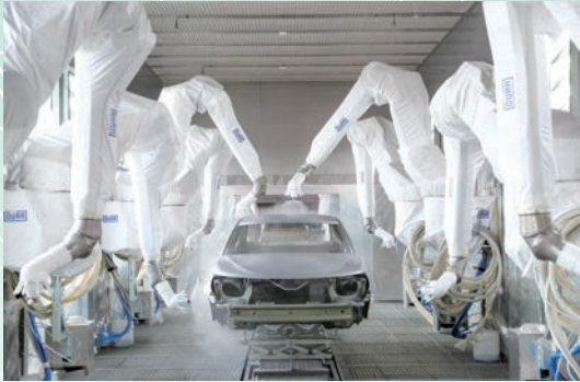
生產基地塗裝車間
