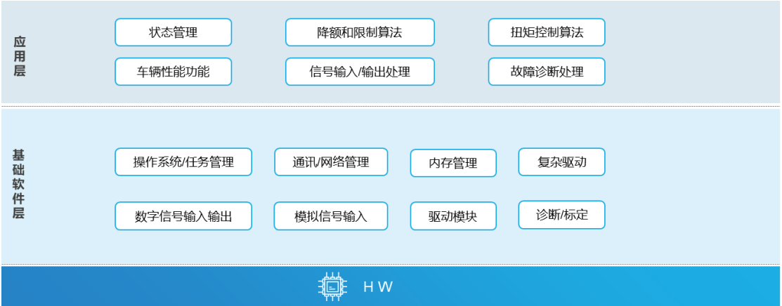
新能源电机控制器软件框架图
