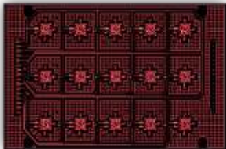
PCB 板跌落测试设计
