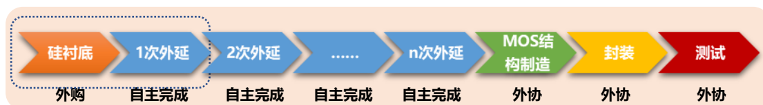
募投项目外延产品生产工艺流程图
