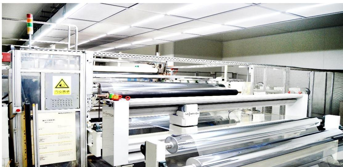
6、横向拉伸。横向拉伸系统由烘箱、链夹和导轨、静压箱、链条张紧器、导
