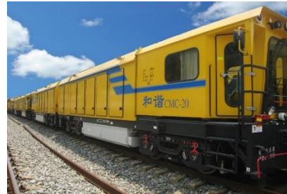
大型养路机械—道岔打磨车 CMC-20
