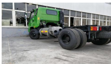
集成式侧挂车载LNG供气系统（容积 160L、200L、240L、275L、330L、335L、 375L、450L、500L）
