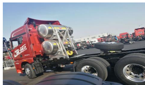
双瓶后背式车载LNG供气系统（容积 450L、500L、750L）
