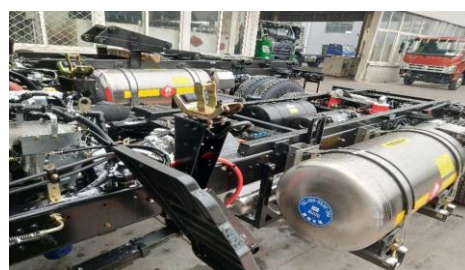
分体式侧挂车载LNG供气系统（容积 160L、200L、240L、275L、330L、335L、 375L、450L、500L）
