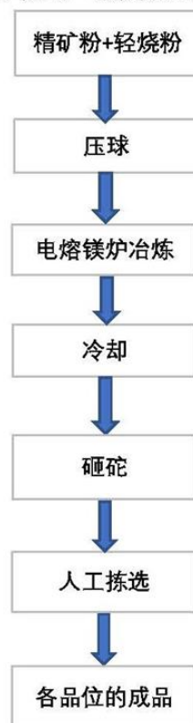
精矿粉生产电熔镁砂工艺流程
