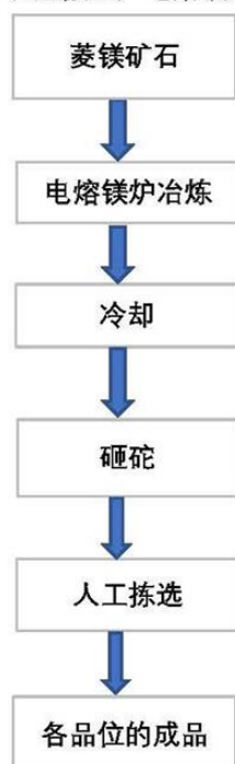
菱镁矿石直接生产电熔镁砂工艺流程
