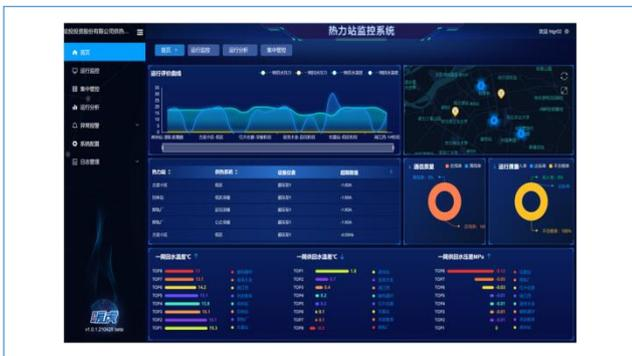
2021 年，推出了基于云服务的热力站监控系统平台，该平台具备 SCADA 系统功能，增加了精准控制策略、智能报警方案、运行分析、设备诊断等功能，全面支持热力站级智慧供热系统运行。
