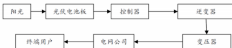
光伏发电生产流程图
