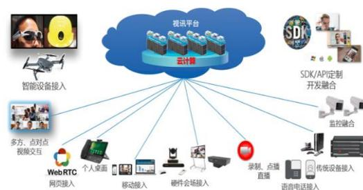
平治东方融合视频会议系统创新地将传统视频会议终端、移动手机端、PC 电脑端、会议平板、个人桌面端、PSTN 电话、IP 电话等接入到一个平台，受到电力、政府、铁路、金融等客户的青睐。
