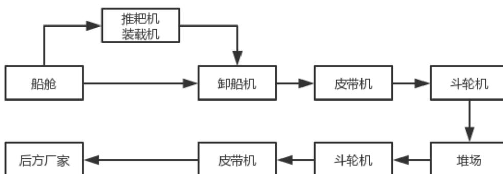
煤炭装卸业务主要流程如下：煤炭货船到港后，由卸船机从船舱（推耙机、装载机用于辅助清仓）抓取物料并转送到地面皮带机；地面皮带机将物料输送至后方堆场，并
