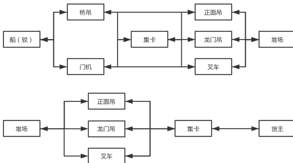
集装箱装卸业务主要流程如下：集装箱货物到港后，地面人员通过桥吊或门机将集装箱从货船上吊至集卡（或临时堆放在码头前沿）；货物卸载完毕后通过集卡运至后方堆场，再由正面吊、龙门吊或叉车进行堆存；发货时，地面人员采用龙门吊、正面吊或叉车将在堆场存放的集装箱吊到集卡，并运至货主指定的地点。
