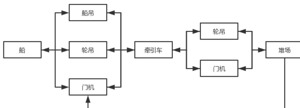
件杂货装卸业务主要流程如下：货船到港后，工作人员通过船吊、轮吊或门机将船上件杂货吊至牵引车上；牵引车将件杂货运输至后方堆场，再由轮吊、门机等进行堆存；发货时，由门机、轮吊等在后方堆场将件杂货直接吊上汽车，运送至货主指定地点。
