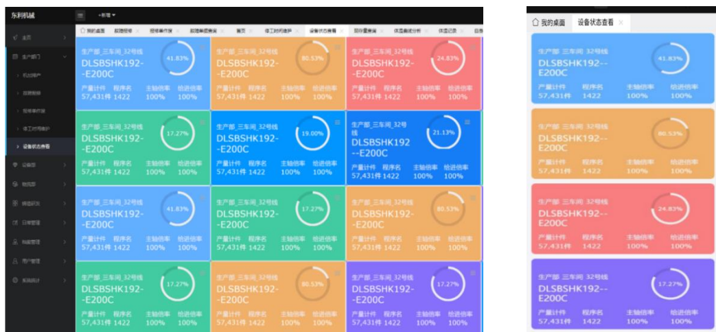
图：机加设备状态监控系统（左图：PC 端；右图：移动端）
