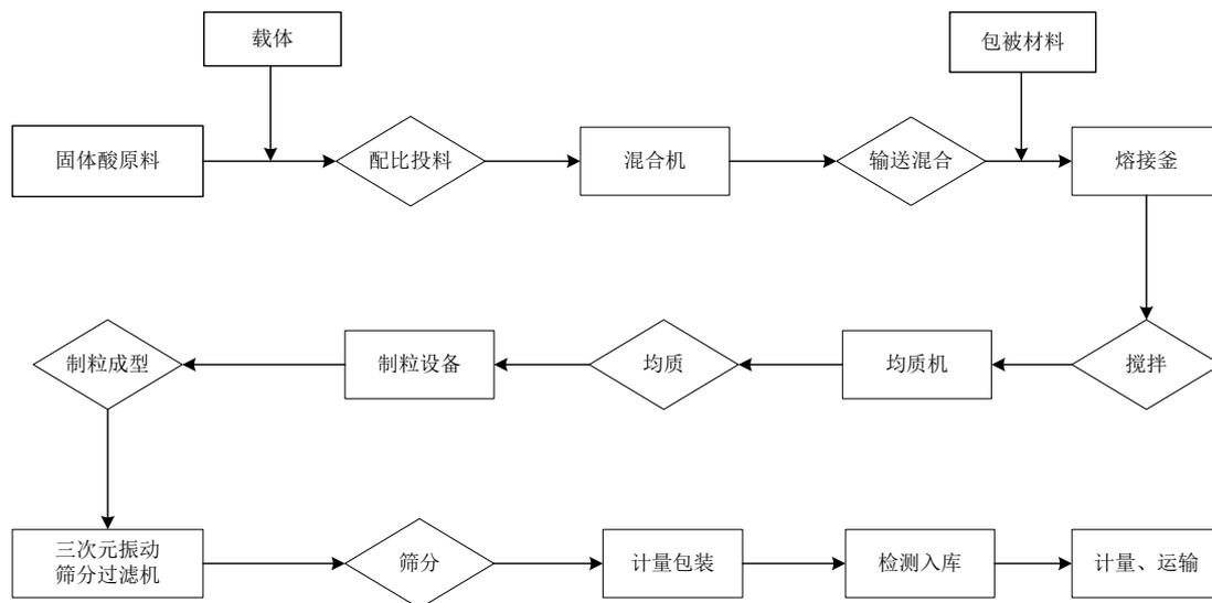
①配比投料：根据配比方案，将固体酸原料和载体配比称重；
