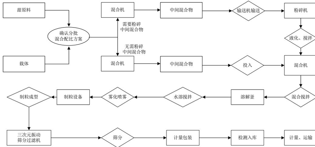
①甜原料预处理：根据配比方案，将多种甜原料称量后投入混合机，搅拌均匀的混合物，然后经输送机输送进入粉碎机，进行粉碎形成一定粒度的甜原料混合物，目的是加快后段工序溶液配置的速度。
