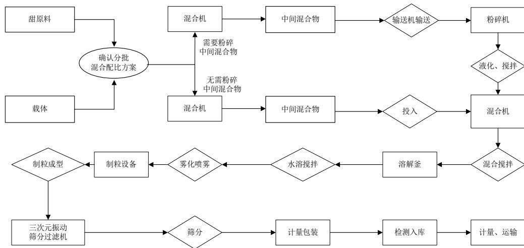
①甜原料预处理：根据配比方案，将多种甜原料称量后投入混合机，搅拌形成均匀的混合物，然后经输送机输送进入粉碎机，进行粉碎形成一定粒度的甜原料混合物，目的是加快后段工序溶液配置的速度。
