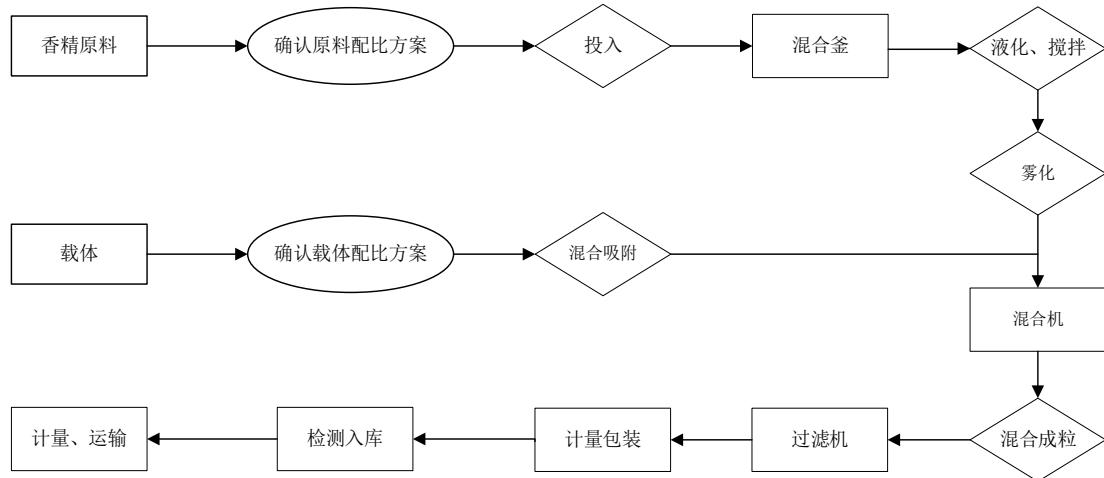
①液体香基配置：根据配比方案，将称量好的固体香精原料投入混合釜内，加热熔化为液体，然后再加入称量好的液体香精原料，搅拌混合均匀，形成澄清透明的均一溶液。
