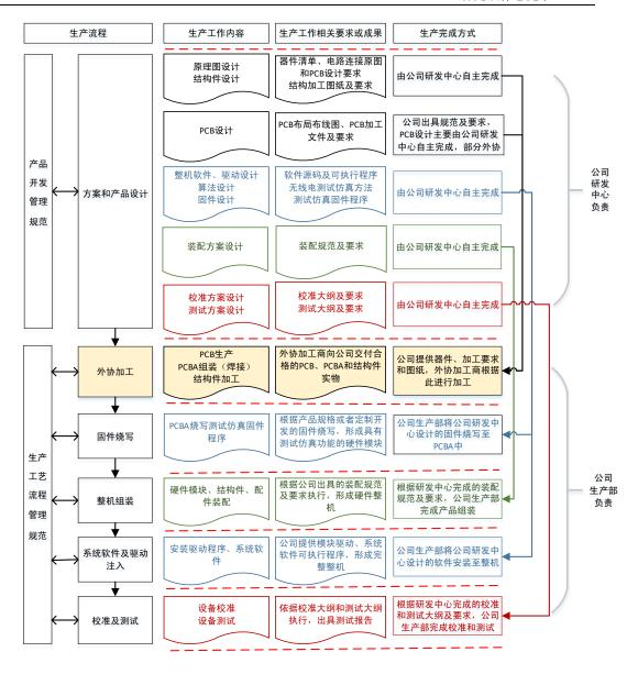
公司生产流程中除 PCB 生产、结构件加工和 PCBA 焊接交由外协加工商按照公司提供的图纸和要求进行的委外加工环节外,其他环节均为公司的核心工艺生产环节,核心环节的生产内容及过程如下:
