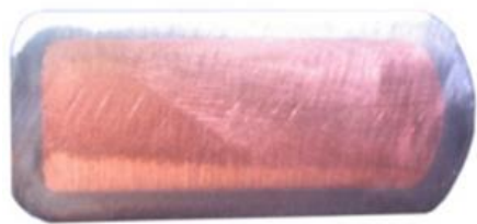
图 1 钢包铜导电梁截面图
