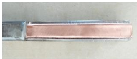
图 2 钢包铜梁两端露铜
