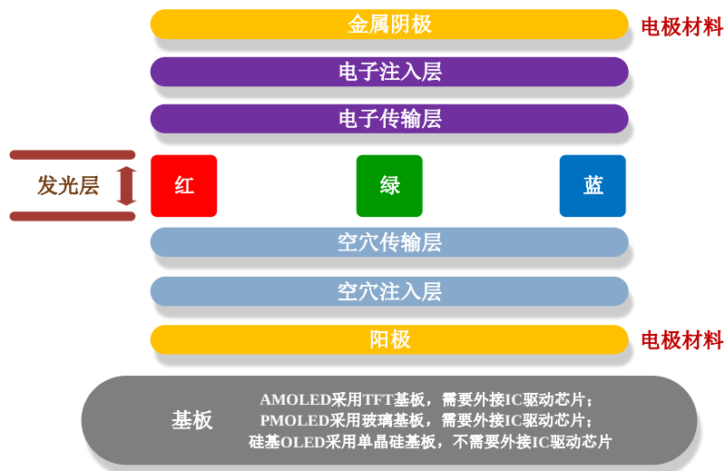
OLED 结构图
