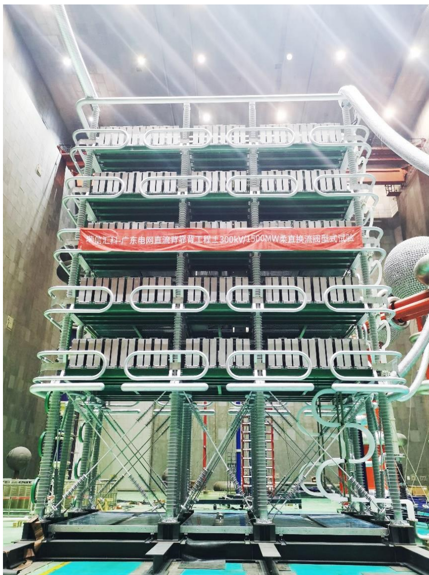
图6 公司供货的广东电网公司直流背靠背工程柔直换流阀型式试验现场
