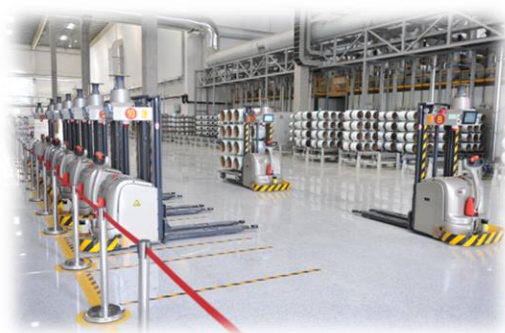
AGV 搬运系统
