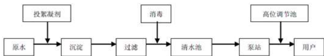
图：自来水生产工艺流程图
