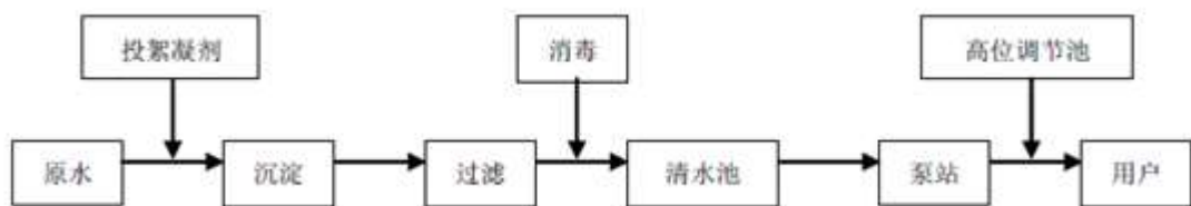
图：自来水生产工艺流程图
