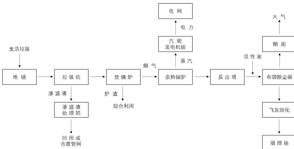
垃圾焚烧发电系统的核心设备是焚烧炉，公司主要使用自主研发的三驱动逆推式炉排炉，该种焚烧炉具有独特的一体式三段设计，干燥、燃烧、燃烬段均配置独立驱动机构，可灵活根据燃烧工况调整各段的运行速度，以更好地控制火床分布，使得灰渣热灼减率更低。
