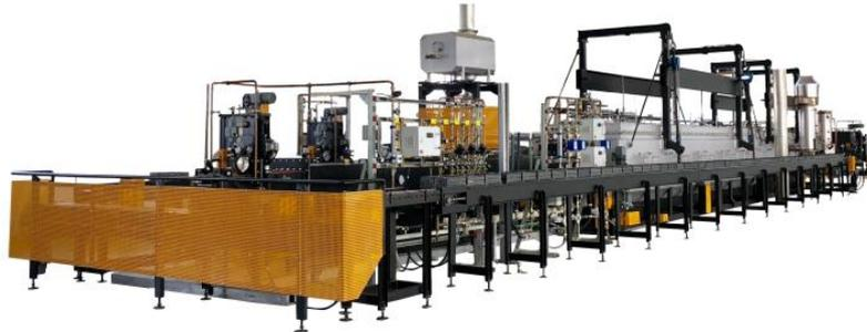
如下图所示，连续炉的炉腔主要由装料段、预热段、催化脱脂段（酸脱）、脱剩余粘结剂段、烧结段、冷却段等区段组成，通过横向传送带连接，不同区段的温度、功能不同。
