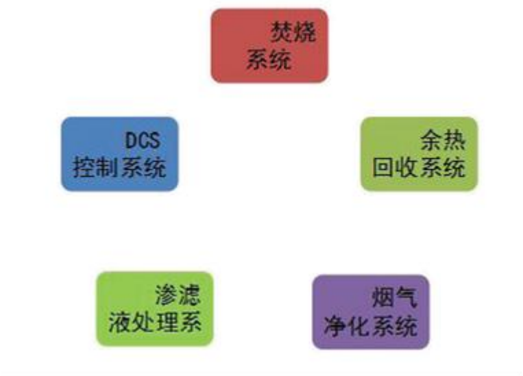
图：生活垃圾焚烧处理工艺流程（炉排炉）
