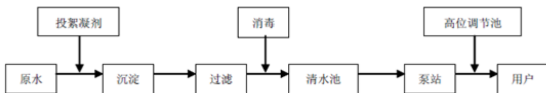
图：自来水生产工艺流程图
