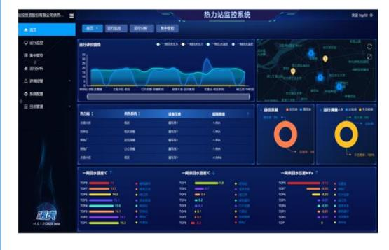
2021 年推出了基于云服务的热力站监控系统平台，该平台具备 SCADA 系统功能，增加了精准控制策略、智能报警方案、运行分析、设备诊断等功能，全面支持热力站级智慧供热系统运行。
