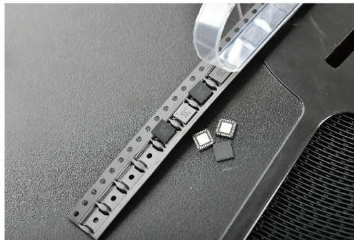
包含我們的MEMS及感應器封裝產品的 寬度為16毫米的載帶，僅供說明用途
