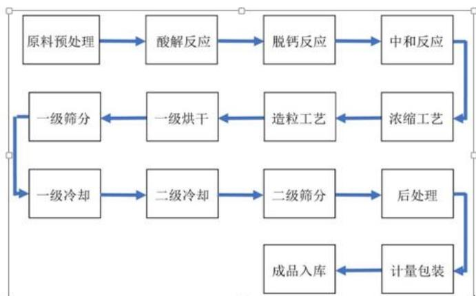
(4) 水溶性肥料生产工艺流程图
