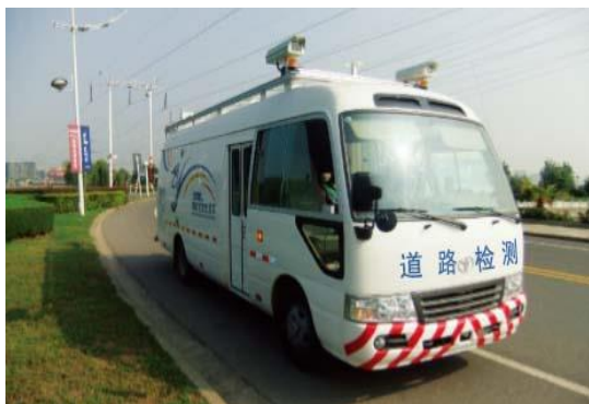
道路综合检测车检测路面质量
