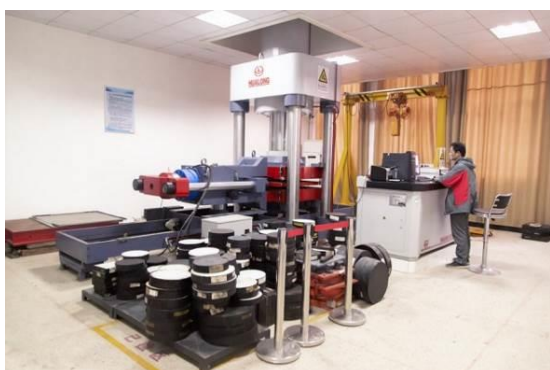
盆式支座竖向压缩变形试验
