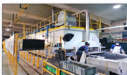
全自动气氛保护钎焊炉
