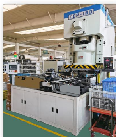
全自动集液管扁管槽冲压生产线
