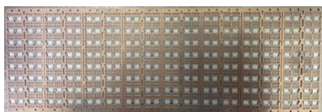
SOP 8L 的 8 排引线框架
