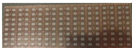
SOP 16L 的 8 排引线框架
