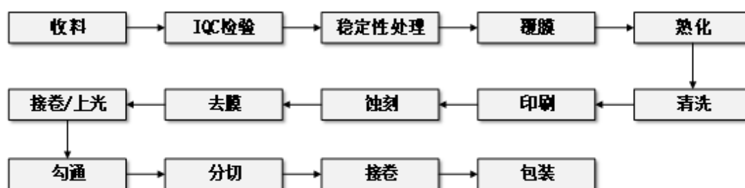
RFID 电子标签生产工艺图
