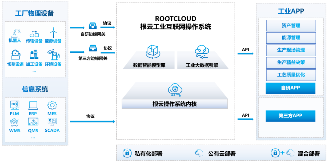
图：智能制造 IIoT 解决方案基本框架
