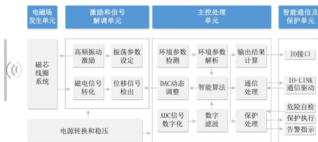
兰宝传感的智能计算单元设计应用示意图（以智能电感式为例）
