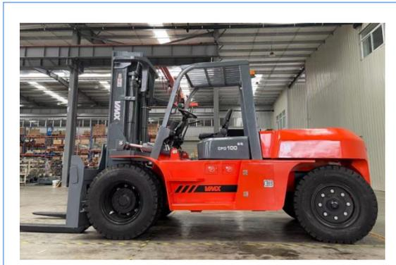
报告期内，公司完成了重装新能源系列4-5吨和5-10吨电动平衡重式叉车整车和关键零部件的开发，并已进入批量生产阶段。
