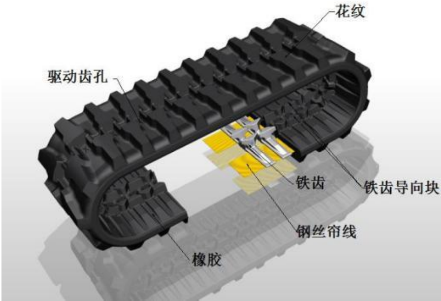
橡胶履带横切面
