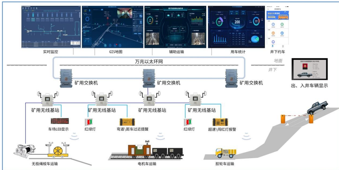
智能矿山辅助运输监控系统
