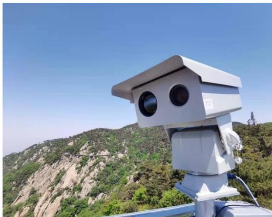
林区大事，防火第一。四川省某应急管理局大批量引进山东华网智能科技股份有限公司自主研发生产的森林防火预警系统产品，本系统产品在前端利用视频监控技术结合智能化的烟火识别技术，对数公里范围内的森林资源进行监测，通过智能化的森林防火预警手段，不仅可以实时监看和记录森林资源情况，而且采用了智能化的监测机制，通过智能化设备自动完成对森林资源的火灾监测和报警，辅助森林防火监测人员完成对森林资源的自动监测，是一种由传统的人工监测转变为由机器自动监测的智能化科技手段。
